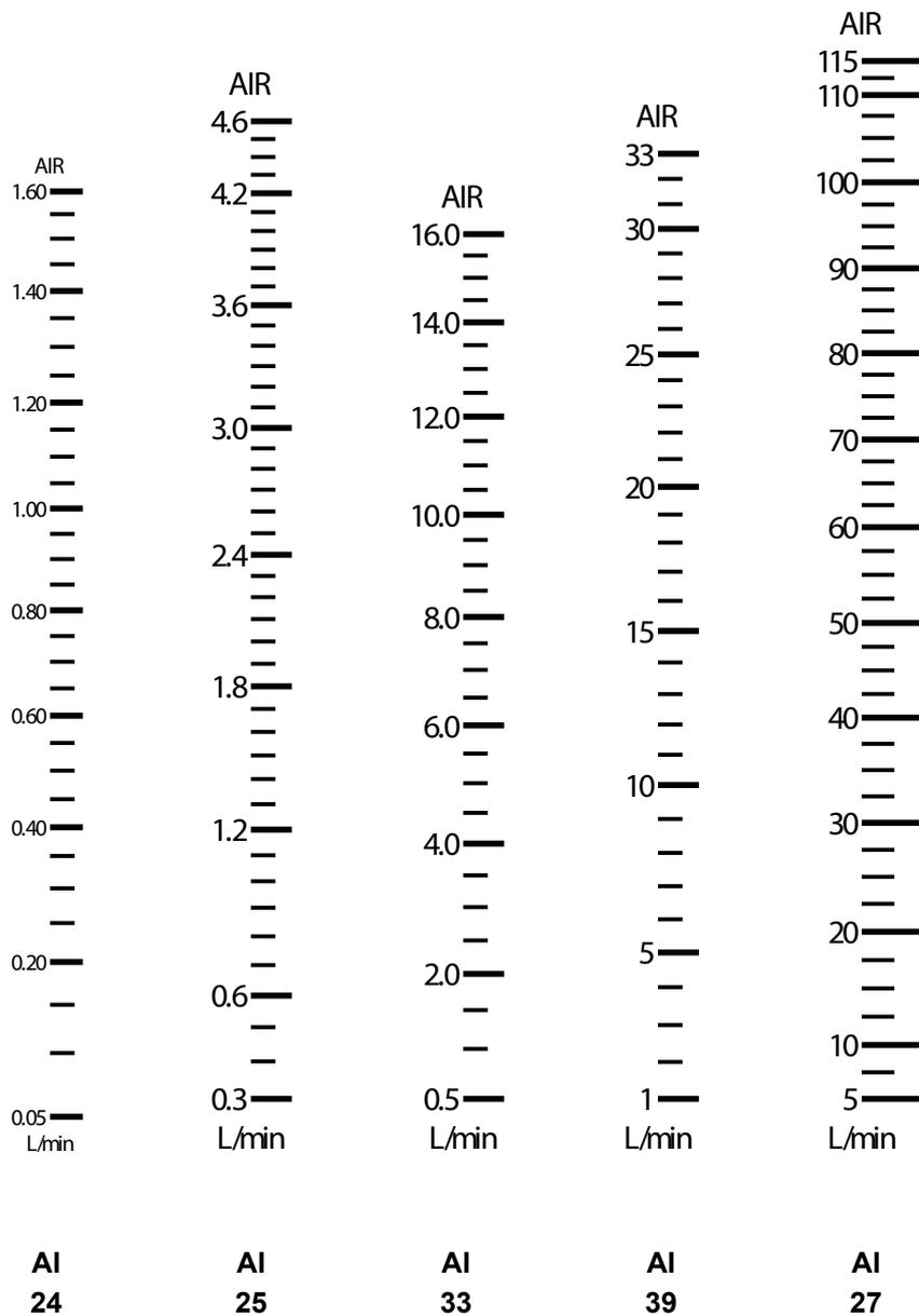
Alle Lang-Skalen sind auf Betriebsbedingungen von 20 °C, 1,01325 bar abs und einer Abströmung gegen atmosphärische Druck (20 °C, 1,01325 bar abs) ausgelegt
