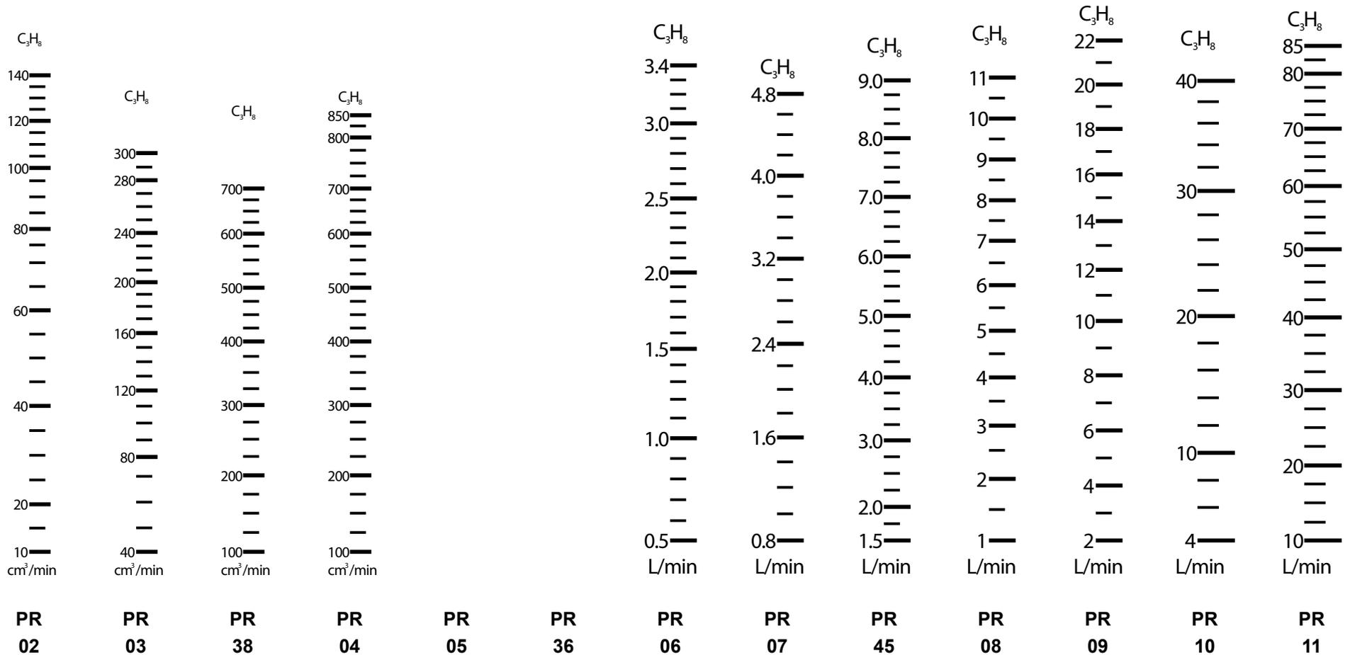
Alle Standard-Skalen sind auf Betriebsbedingungen von 20 °C, 1,01325 bar abs und einer Abströmung gegen atmosphärische Druck (20 °C, 1,01325 bar abs) ausgelegt
